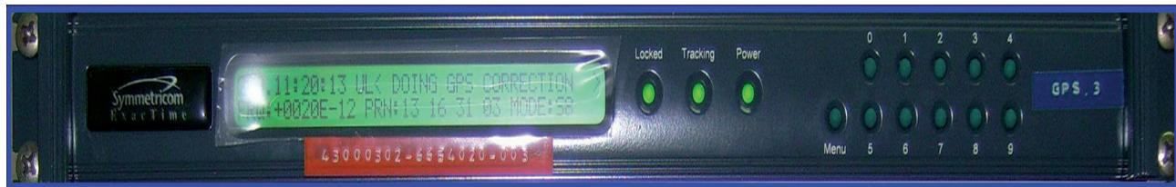
ภาพที่ ๕-๕ เครื่องรับสัญญาณเวลาด้วยดาวเทียม ระบบ GPS ตราอักษร Symmetricom
