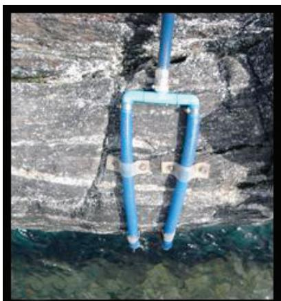
ภาพที่ ๓ - ๕๘ การติดตั้งหัวเซนเซอร์ของเครื่องวัดระดับน้ำระบบดิจิตอล
