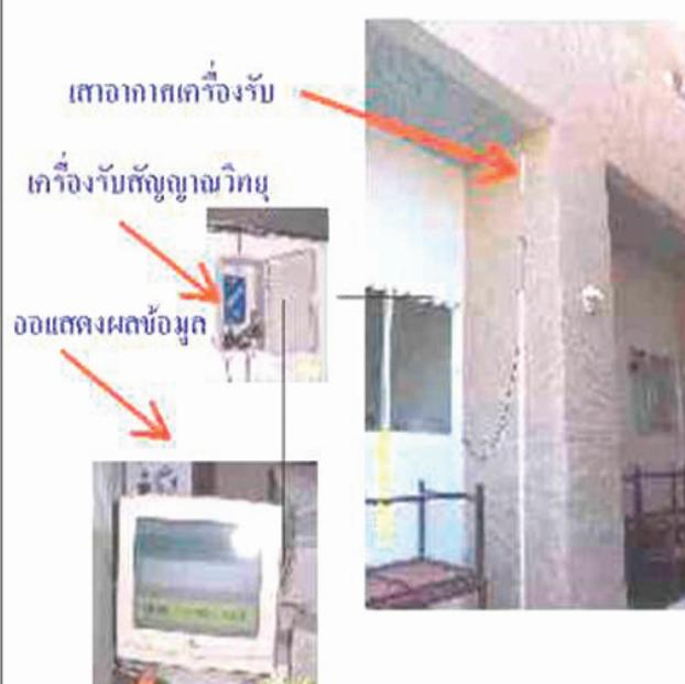
ภาพที่ ๕ - ๐๖ ส่วนประกอบของเครื่องมือและอุปกรณ์ตรวจวัดระดับน้ำ แบบวัดความกดดันน้ำ
