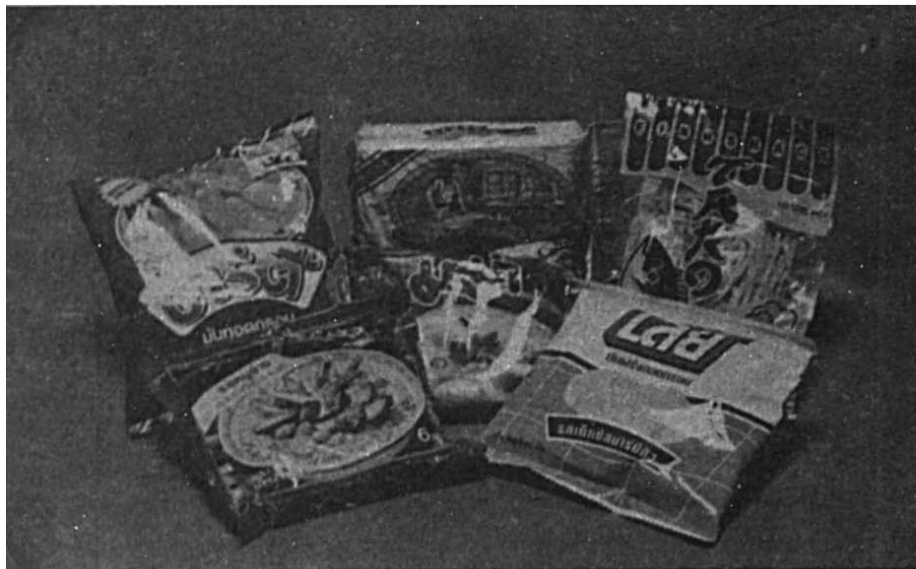
ภาพที่ 5.35 ตัวอย่างสิ่งพิมพ์ประเภทบรรจุภัณฑ์ชนิดอ่อนตัวที่พิมพ์ด้วยระบบการพิมพ์กราฟวัวร์
