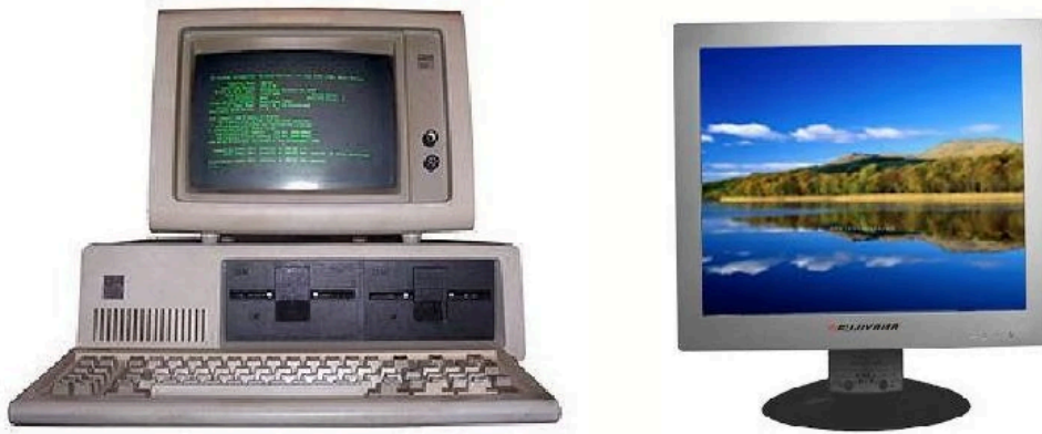
รูปที่ 25 จอภาพโมนโครม (ซ้าย) และจอภาพสี (ขวา) ที่มา http://en.wikipedia.org/wiki/Monochrome_monitor http://komtik4.blogspot.com/2011/07/monitor.html
