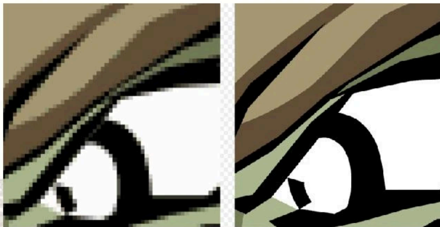
รูปที่ 24 ภาพกราฟิกแบบราสเตอร์ (ซ้าย) และภาพกราฟิกแบบเวกเตอร์ (ขวา)
